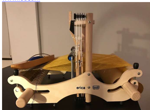
Prototype van de Erica uitgevoerd met 3 schachten.
