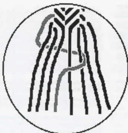
Detail van de 1ste stap. Vanaf links de buitenste draad onder 5 draden en over 2 draden. Daar laten hangen.
