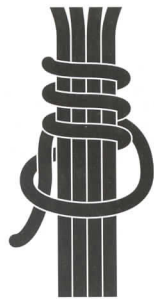
De wikkeltechniek en de afhechting van de draad.
