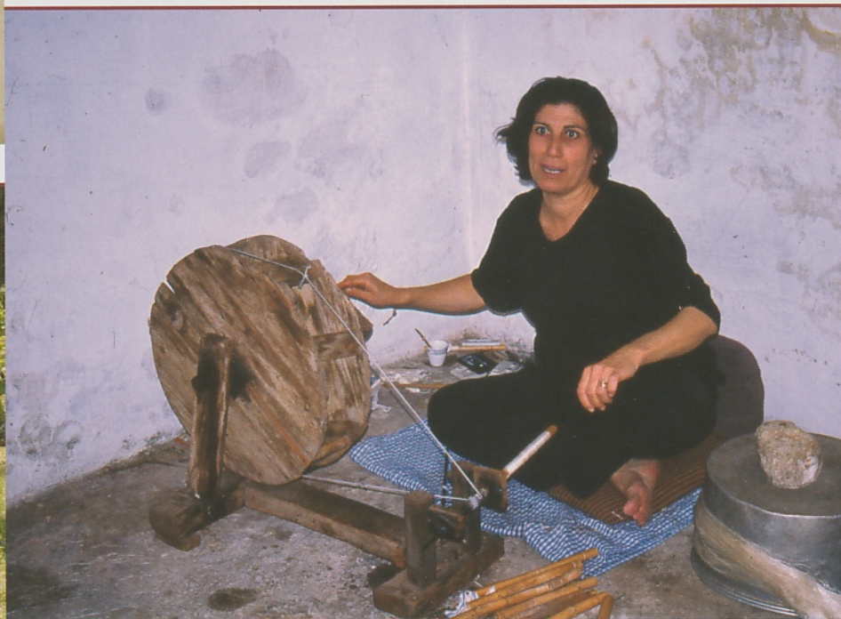
Amal aan het spinnewiel waar ze van een vochtige streng spoelen windt op rieten kloesjes.
