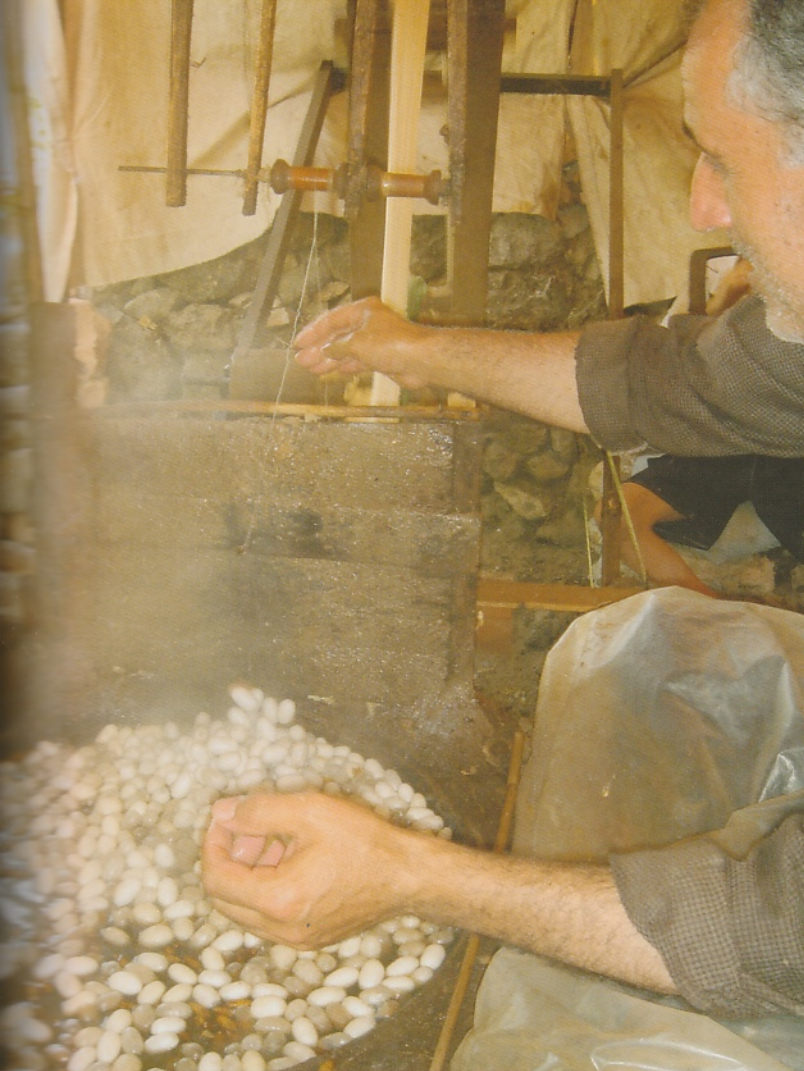
De begin van de draden wordt toegevoegd aan de draden van de reeds afwinnende coccons. Op de achtergrond de haspelmolen.
