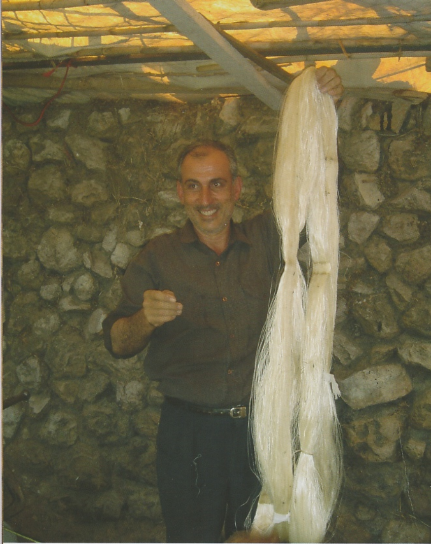
Een streng met afbindingen. Goed te zien zijn de 'moeten' op de plek waar de pootjes van de haspelmolen de draden tegen elkaar aandrukken en ze aan elkaar vastkleven door de zijdelijm.
