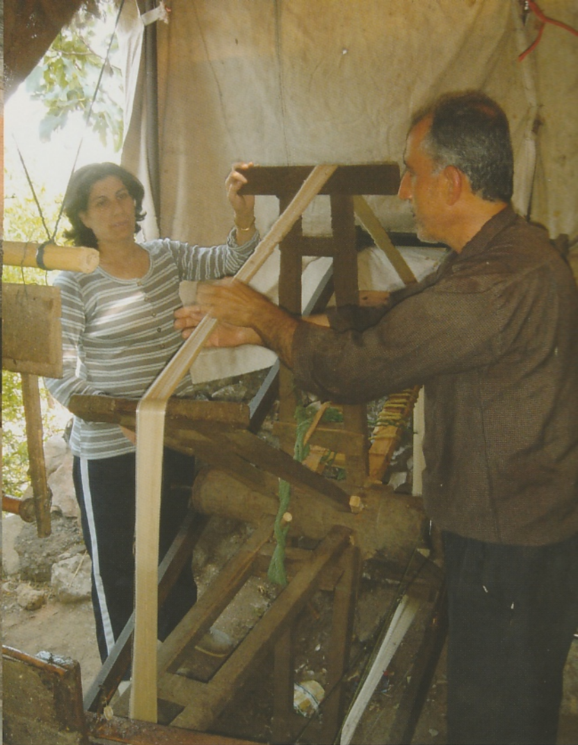
Een streng is klaar. Op regelmatige afstand wordt een afbinding gemaakt. Om de streng te verwijderen wordt een spaak uit het haspelwiel genomen.
